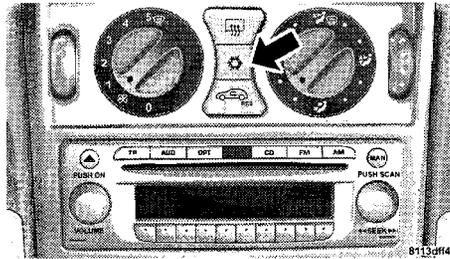
Pour recevoir l'air extérieur par les bouches du panneau, arrêtez la climatisation. Le témoin du commutateur doit s'éteindre. Réglez les commandes comme pour la climatisation de base.
