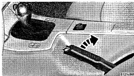
Pour relâcher le frein de stationnement, tirez légèrement la poignée en poussant le bouton de verrouillage, puis abaissez le levier jusqu'à la butée. Le témoin d'avertissement des freins du bloc d'instruments doit s'éteindre.
