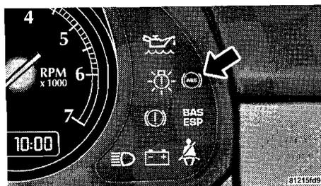
Si le témoin ABS du bloc d'instruments s'allume lorsque le moteur tourne, il indique que l'ABS a détecté une défaillance et a été désactivé. Dans ce cas, le système de freinage fonctionne normalement, mais sans assistance antiblocage. Lorsque l'ABS est défectueux, le BAS et l'ESP sont
