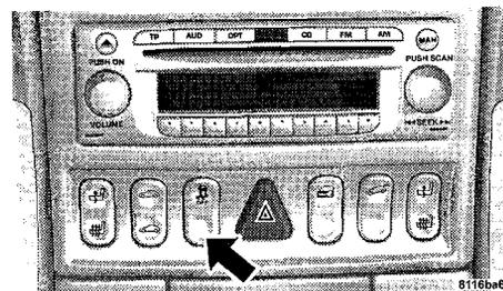
Pour accroître la motricité du véhicule en conduite avec des chaînes à neige ou lors d'un démarrage dans la neige profonde, le sable ou le gravier, désactivez l'ESP en appuyant sur la partie supérieure du commutateur ESP. Le témoin ESP restera alors continuellement allumé. Lorsque le système ESP est désactivé, le dispositif de réduction du couple moteur est hors fonction. De ce fait, l'amélioration de la stabilité du véhicule offerte par l'ESP n'est plus disponible.
