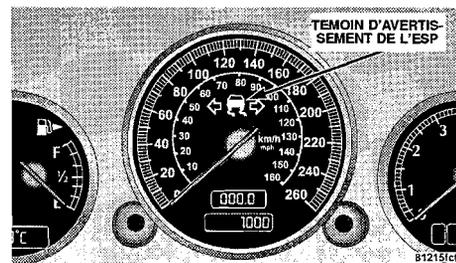
En hiver, l'efficacité de l'ESP peut être améliorée en équipant le véhicule de pneus radiaux M+S (boue-neige) préconisés par DaimlerChrysler et/ou de chaînes à neige.
