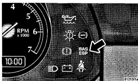
Le témoin BAS/ESP du bloc d'instruments s'allume lorsque la clé est en position ON/RUN et doit s'éteindre lorsque le moteur tourne. Si le témoin de panne BAS/ESP s'allume continuellement lorsque le moteur tourne, c'est qu'une panne a été détectée dans le BAS ou l'ESP. Ceci peut entraîner une baisse de puissance du moteur requérant une pression plus importante de la pédale d'accélérateur.
